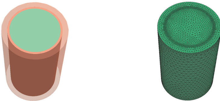
Rys. 4. Siatka 3D kompletnego modelu numerycznego czujnika pojemnościowego
