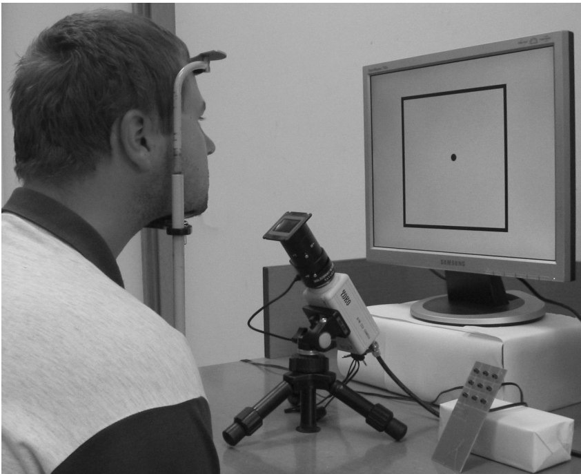
Rys. 2. Stanowisko do akwizycji obrazu oka. Składa się z kamery czarno-białej z filtrem światła widzialnego, oświetlacza promieniowaniem podczerwonym (prawy dolny róg zdjęcia) oraz statywu do unieruchomienia głowy
