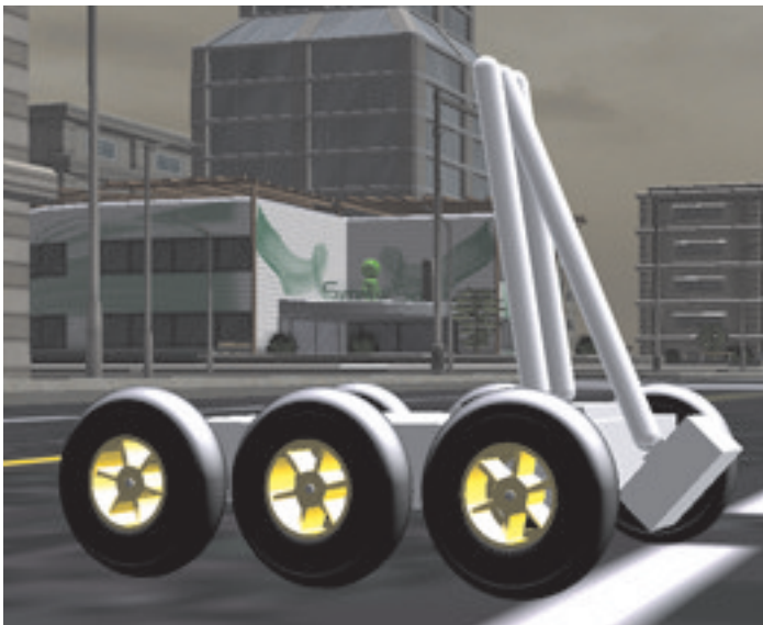
Rys. 6. Niemożliwa do osiągnięcia konfiguracja ramienia
