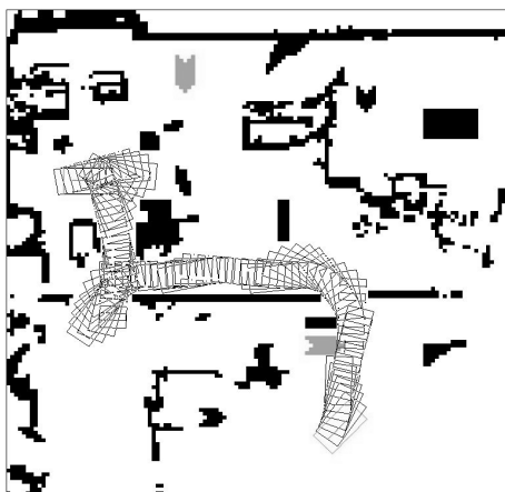
Rys. 5. Przykład nawigacji robota w środowisku z ruchomymi przeszkodami i ze zmianą trasy wynikającą z omijania ruchomej przeszkody
