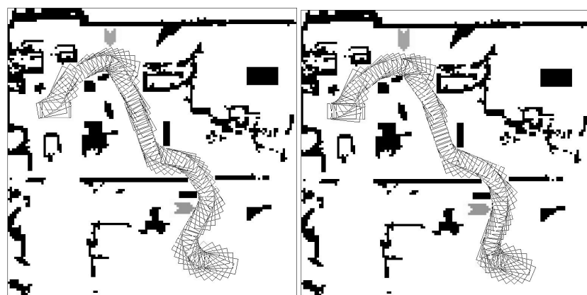
Rys. 4. Przykład nawigacji robota w środowisku z ruchomymi przeszkodami Objaśnienia w tekście
