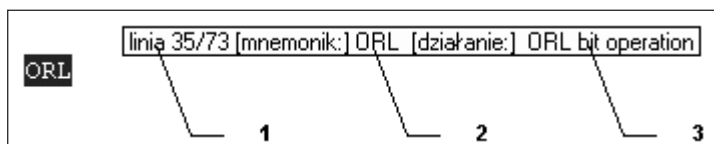
Rys. 5. Menu kontekstowe: 1 – aktualne położenie kursora oraz całkowita liczba linii, 2 – aktualnie przetwarzany mnemonik, 3 – krótki opis danej operacji
