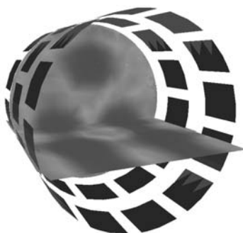
Rys. 9. Rekonstrukcja po symulacji 36-elektrodowego czujnika 3D ECT
