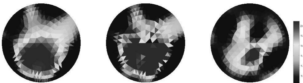
Rys. 7. Obraz tomograficzny zrekonstruowany: a) metoda SIRT (problem prosty rozwiązywany w sposób liniowy); b) metoda SIRT (problem prosty rozwiązywany w sposób nieliniowy); c) metoda Gaussa–Newtona
