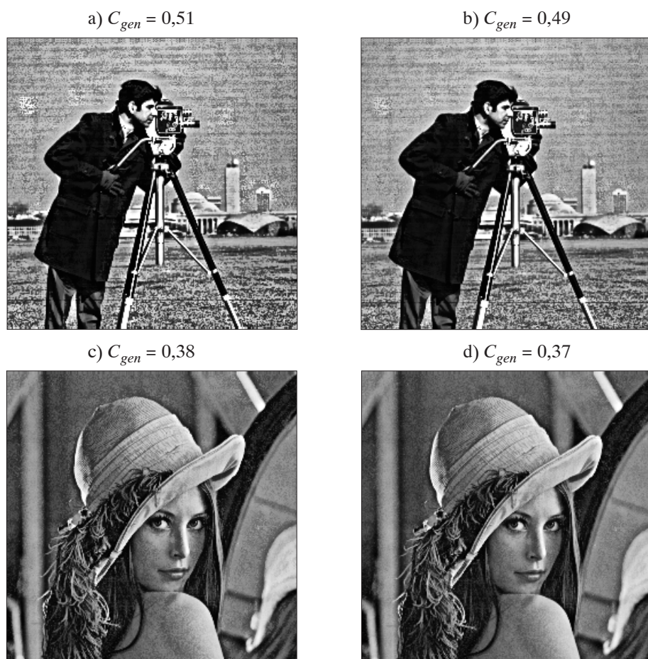
Rys. 4. Obrazy z rysunku 1 po przekształceniu, z uwzględnieniem podejścia (13) i (14) we wzorze na kontrast lokalny (12) i obliczaniem \beta za pomocą wzoru (11): a) \gamma = 1 oraz \beta_{min} = 0,2 i \beta_{max} = 0,6 ; b) \gamma = 0,5 oraz \beta_{min} = 0,2 i \beta_{max} = 0,6 ; c) \gamma = 1 oraz \beta_{min} = 0,5 i \beta_{max} = 0,8 ; d) \gamma = 0,5 oraz \beta_{min} = 0,5 i \beta_{max} = 0,8
