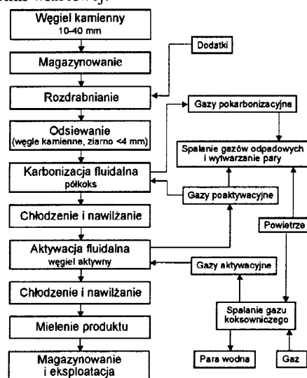
Rys. 2. Schemat otrzymywania nośników węglowych metodą fluidalną [4]
