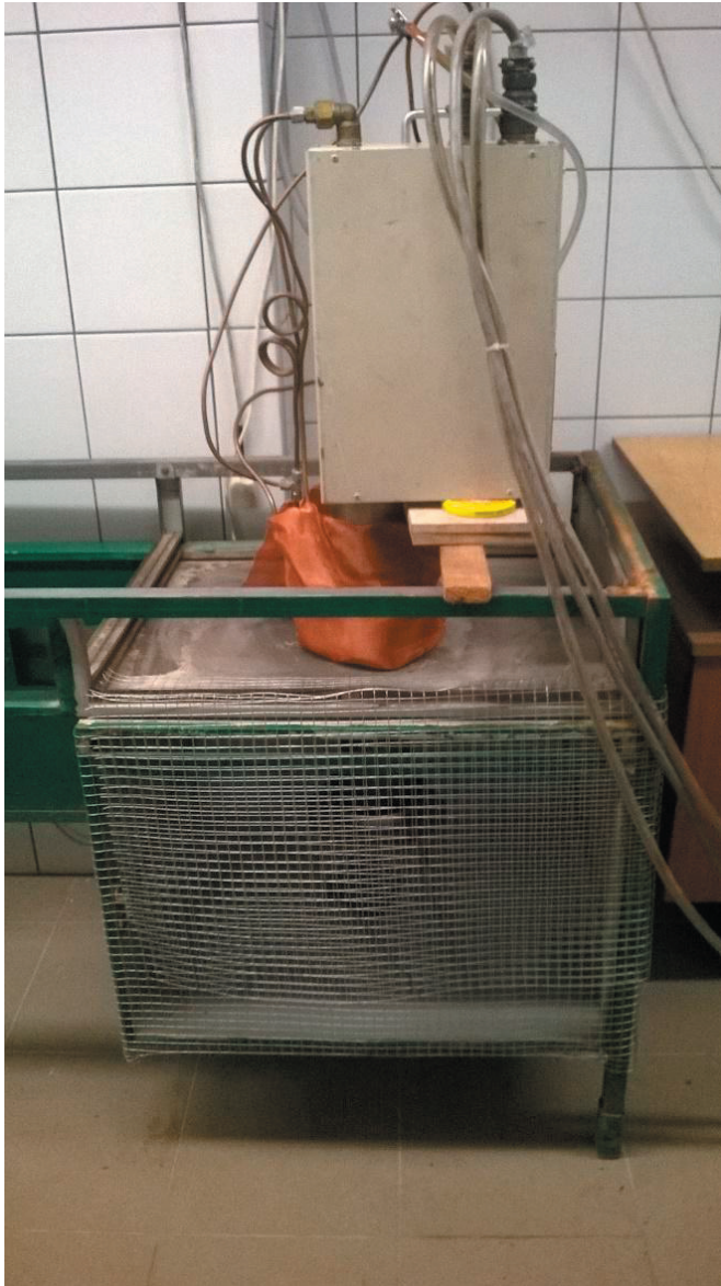
Rys. 1. Działo mikrofalowe wraz z komorą mikrofalową użyte w doświadczeniach
