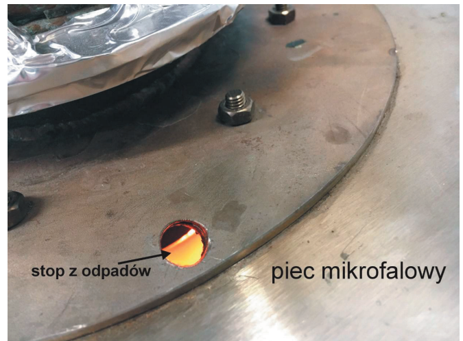
Rys. 3. Stop powstały z odpadów widoczny w oknie pieca mikrofalowego Fig. 3. Stop made of waste visible in the window of the microwave oven
