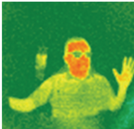
Fig. 12. Thermal images of 320 px \times 320 px resolution after NN (Nearest Neighbour) and the bicubic interpolation ( \times 4 ) of the original 80 \times 80 image Rys. 12. Obrazy termowizyjne o rozdzielczości 320 px \times 320 px po interpolacji metodą najbliższego sąsiada oraz interpolacji bikubicznej oryginalnego obrazu o rozmiarze 80 \times 80 sensorów
