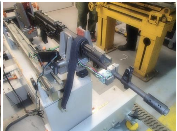
Fot. 4. Kostka z trzema czujnikami akcelerometrycznymi, zamocowana na lufie broni bojowej
