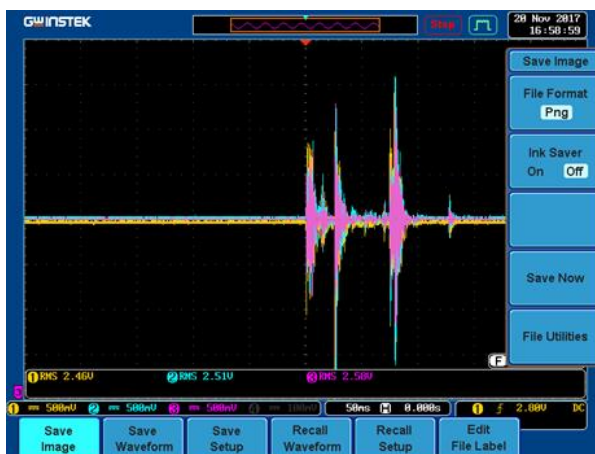
Fot. 7. Przebieg czasowy vibracji bojowego karabinka BERYL zamocowanego na stole badawczym podczas strzału
