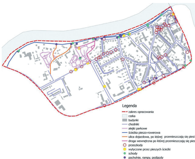
Rys. 2. Istniejące ciągi piesze oraz sposoby pokonywania różnic wysokości terenu
