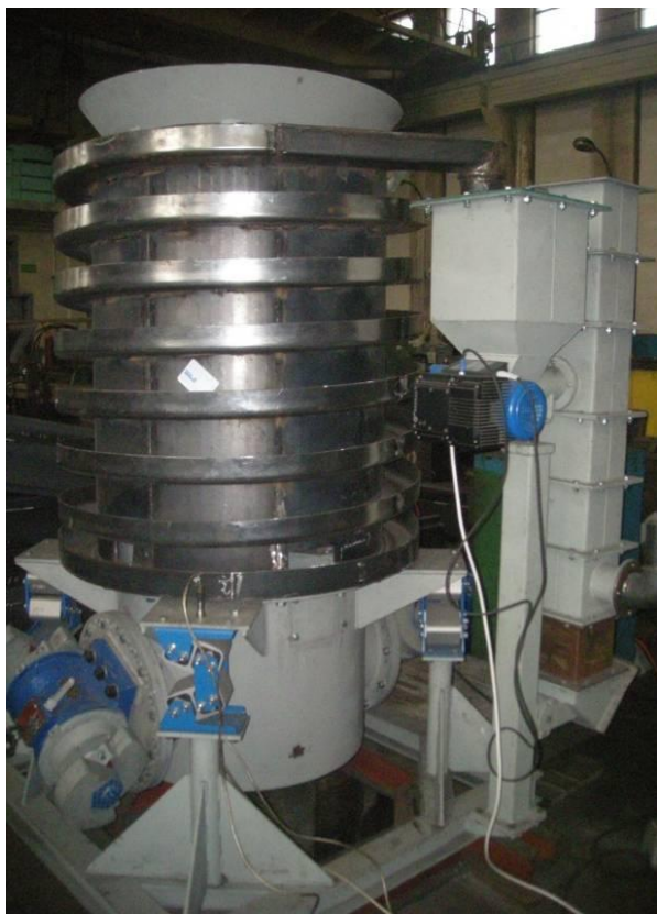
Rys. 4. Widok regeneratora doświadczalnego w stanie surowym na tle układu dozowania regeneratu do klasyfikatora pneumatycznego
