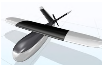
Rys. 7. Model geometryczny projektowanego BSP wykonany w programie NX12 oraz zbudowany BSP gotowy do oblotu
