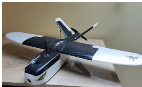
Rys. 7. Model geometryczny projektowanego BSP wykonany w programie NX12 oraz zbudowany BSP gotowy do oblotu
