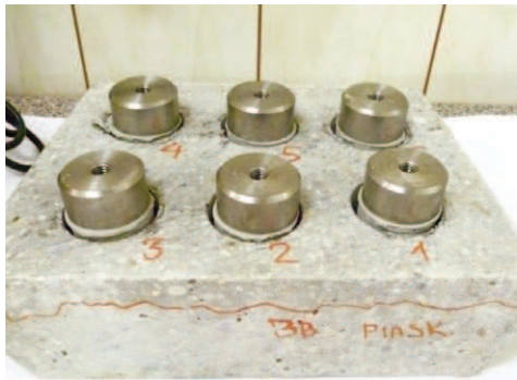
Rys. 2. Element próbny przygotowany do badań przyczepności metodą pull-off
