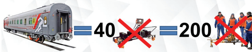
Rys. 15. Jeden wagon defektoskopowy eliminuje 40 urządzeń obsługiwanych ręcznie i 200 pracowników niezbędnych do ich obsługi [11]
