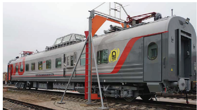
Rys. 5. Wagon Integral na stanowisku kalibracji przyrządów pomiarowych [19]
