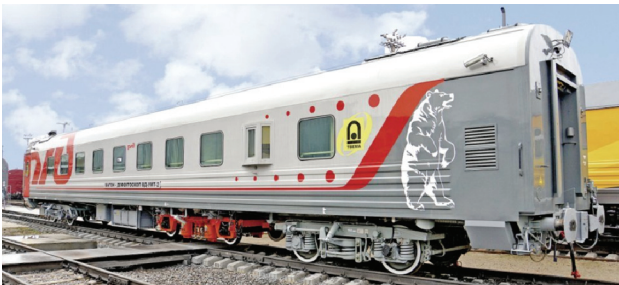
Rys. 6. Wagon defektoskopowy VD-UMT-2 przeznaczony do kompleksowej diagnostyki obiektów infrastruktury kolejowej z wykorzystaniem ultradźwiękowych, magnetycznych i optycznych metod badań nieniszczących [17]
