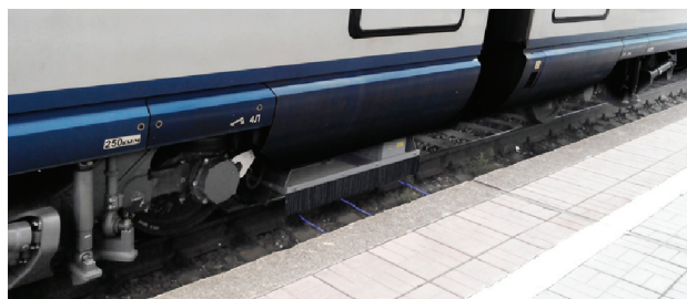
Rys. 12. Urządzenie laserowe w pociągu Sapsan do pomiaru stanu szyn [5]
