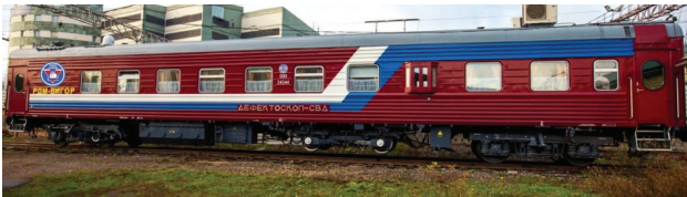
Rys. 3. Wagon defektoskopowy RDM – WIGOR [14]
