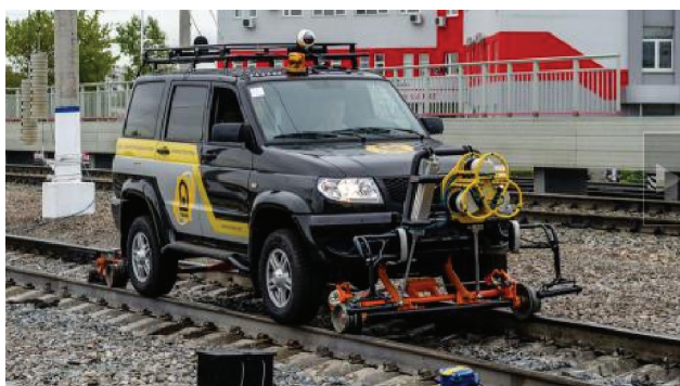
Rys. 14. Pojazd drogowy wykorzystywany do pomiarów infrastruktury torowej [12]
