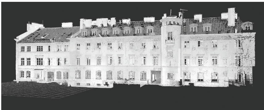
Rys. 1. Widok chmury punktów 3D budynku
