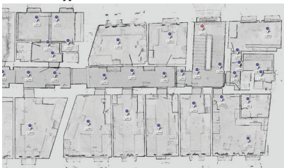
Rys. 7. Widok połączenia dwóch zabytkowych kamienic, widoczne ściany wybudowane pod różnymi kątami
