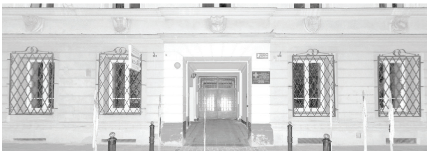
Rys. 2. Widok modelu 3D fragmentu elewacji z wykorzystaniem parametru intensywności odbicia promienia lasera
