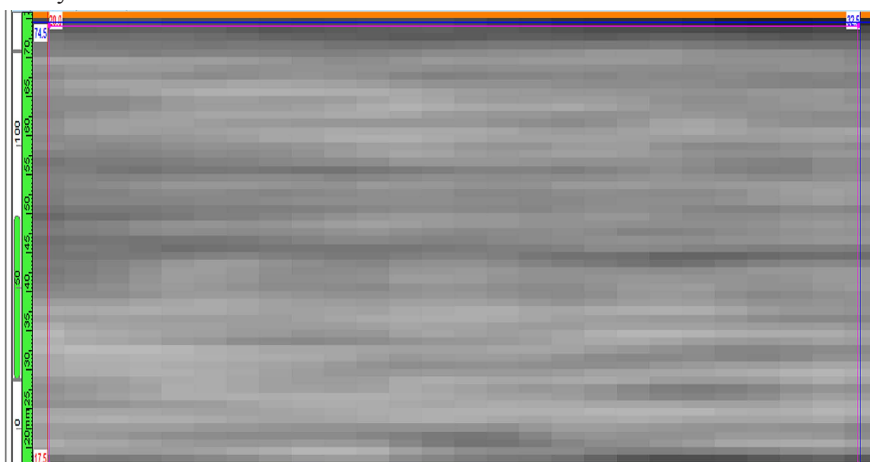
Rys. 9. Badanie NDT ( Non Destructive Test ) metodą ultradźwiękową: zobrazowanie metodą C-Scan [14]
