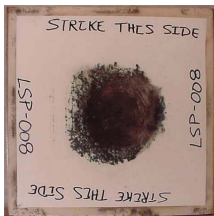
Rys. 15. Panel przekładkowy z miedzianą siatką LSP po uderzeniu pioruna [18]
