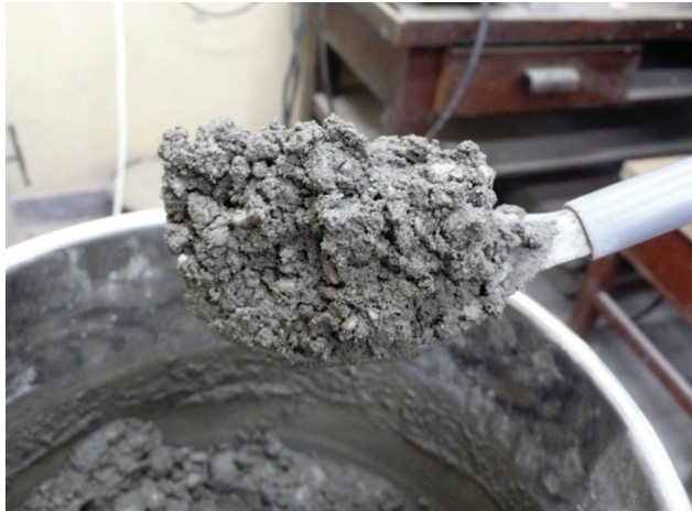
Rys. 2. Struktura betonu wałowanego przed wykonaniem próbek
