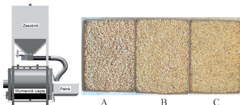
Rys. 2.1. Schemat badanego kotła oraz rodzaje spalanej paliwa: A – pelet drzewny, B – mieszanka peletu i owsa, C – ziarno owsa.
