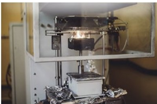
Kalorymetr stożkowy firmy FTT – widok aparatu
