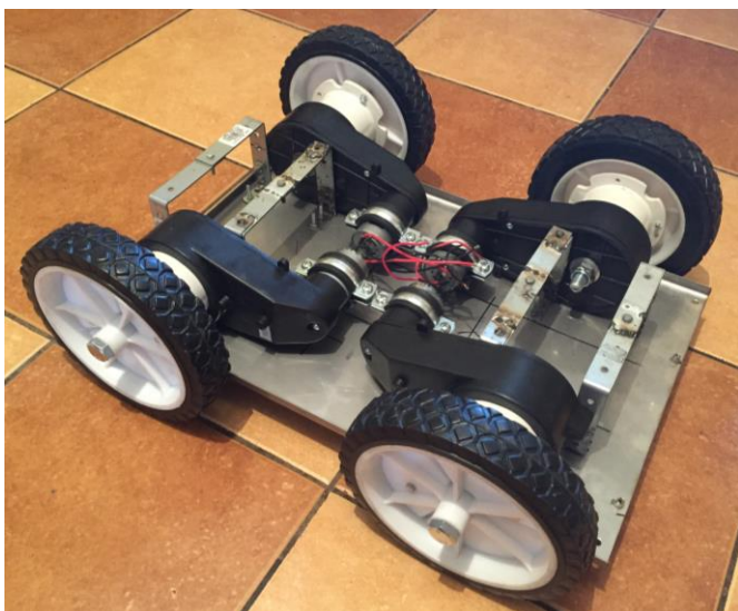
Rys. 13. Podstawa z zamontowanymi silnikami i kołami
