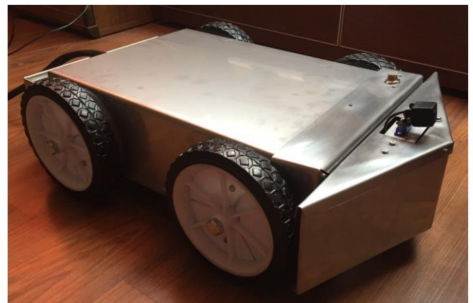
Rys. 16. Wykonanie rzeczywiste robota poszukiwawczo-transportowego
