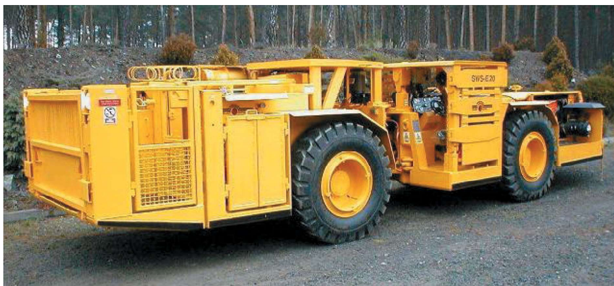
Rys. 4. Prototyp wozu strzałowego SWS-E z modulem do wytwarzania i zatłaczania MWE luzem Fig. 4. Prototype of SWS-E blasting utility vehicle with the mixing-loading unit of bulk emulsion explosives
