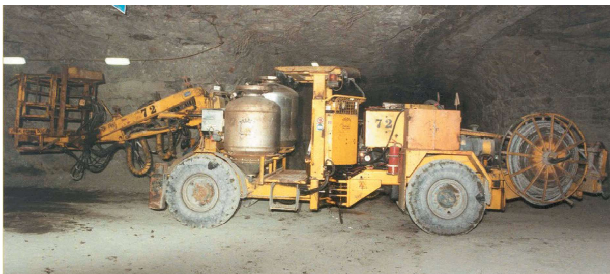
Rys. 3. Samojezdny Wóz Strzałowy typu SWS z modulem do mechanicznego załadunku otworów saletrolem Fig. 3. Blasting Utility Vehicle type SWS with mechanical blasthole loading unit of ANFO
