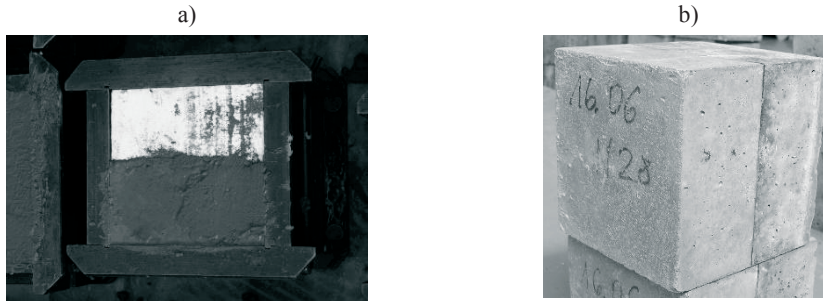
Rys. 2. Próbkę zespolone poddane badaniom: a) forma z ułożonym betonem „starym”, b) próbka zespolona
