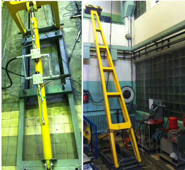
Rys. 2. Stanowisko ze zmiennym obciążeniem do badań układów hydrostatycznych
