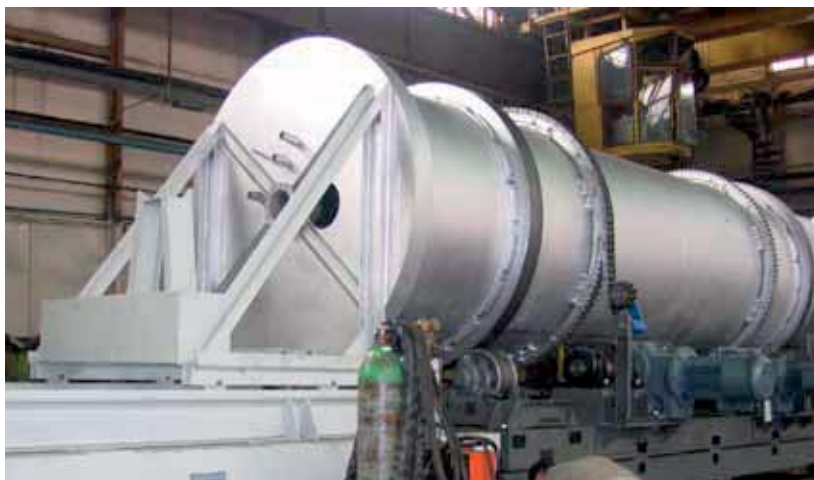
Rys. 3. Widok komory obrotowej do suszenia i pirolizy podczas wstępnego montażu u wytwórcy
