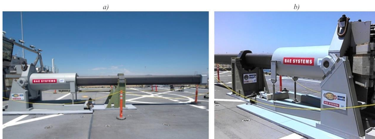
Fot. 3. Model okrętowego dział szynowego koncernu BAE System (a); widok szynowego dział elektromagnetycznego na pokładzie okrętu transportowego USNS "Millinocket" typu JHSV-3 (b) [29] Photograph 3. Model a ship rail gun of BAE System (a); the view of the electromagnetic rail gun on board of the transport ship USNS "Millinocket" type JHSV-3 (b) [29]
