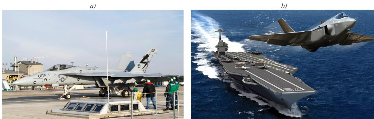
Fot. 1. Pierwszy start samolotu F-18 Super Hornet za pomocą naziemnej katapultы elektromagnetycznej – grudzień 2010 r. (a); wizja przyszłościowa startu samolotu F-35C Lightning II z pokładu lotniskowca Gerald R. Ford (CVN 78) wyposażonego w katapultы elektromagnetyczne(b) [22]
