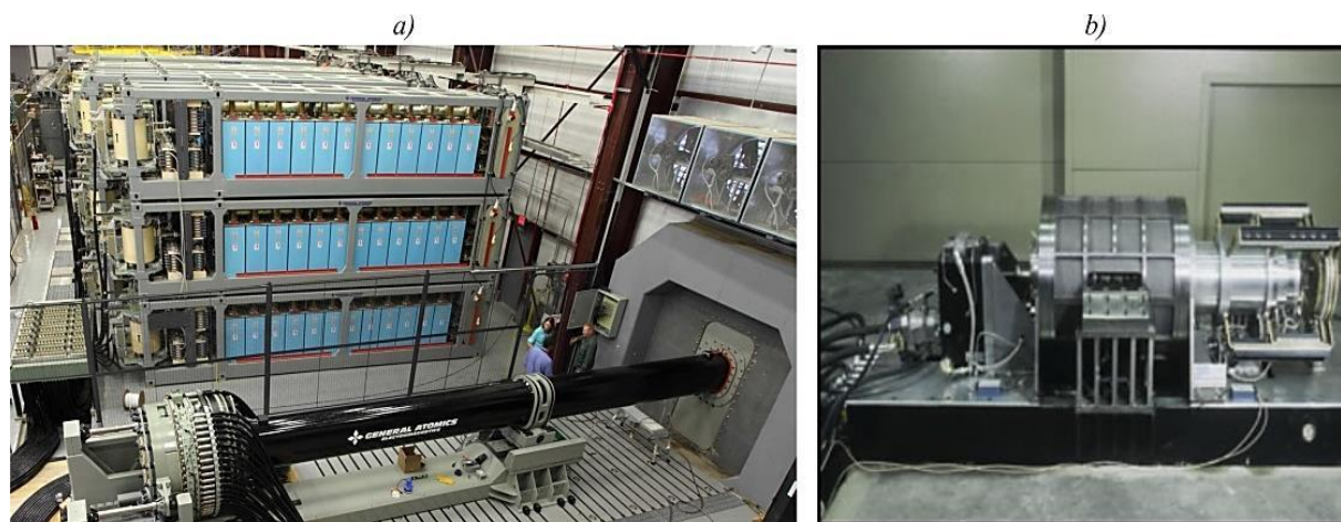
Fot. 6. Bateria kondensatorów zastosowanych do testów dział szynowego firmy General Atomics (a); kompulsator impulsowy z rdzeniem powietrznym zbudowany na Uniwersytecie Texas (b)[37]
