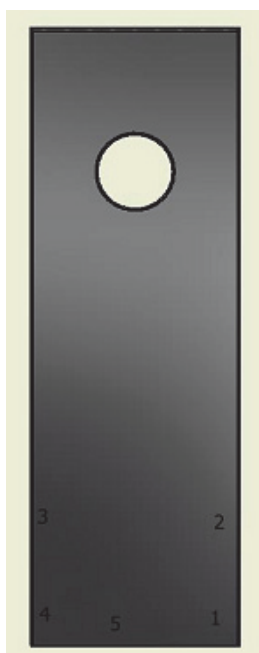
Rys. 14. Miejsca pomiarów twardości próbek bijaków dla danej odległości od krawędzi cięcia Fig. 14. Place for hardness measurements of flail samples for a given distance from the cutting edge
