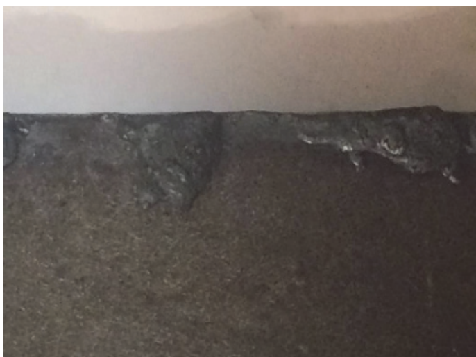
Rys. 9. Widok po cięciu plazmą od strony wyjścia strumienia plazmy (fot. Z. Jarmoliński) Fig. 9. A view after plasma cutting from the exit side of the plasma stream (photo by Z. Jarmoliński)
