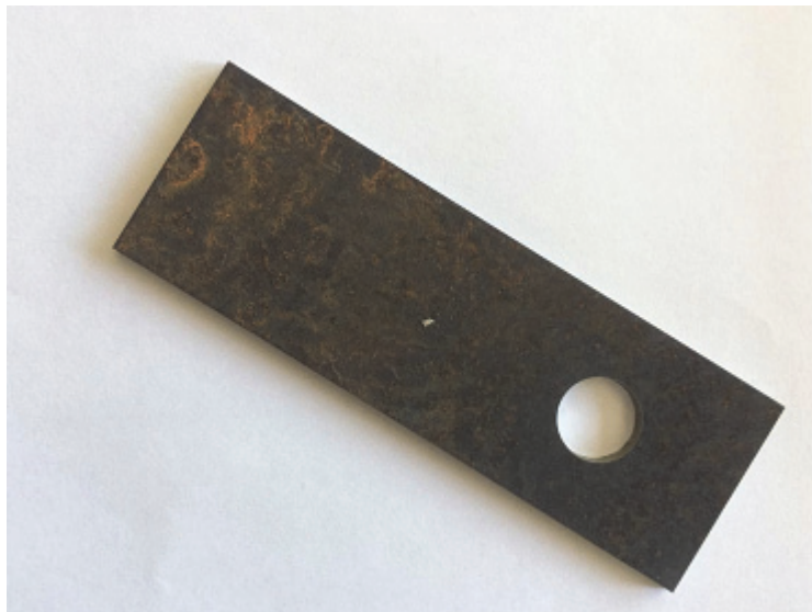
Rys. 6. Widok bijaka konwencjonalnego mocowanego na otworze, wykonanego za pomocą cięcia z wykorzystaniem metody WaterJet (fot. Z. Jarmoliński)
