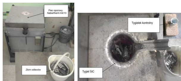
Rys. 3. Piec oporowy Nabertherm z tygłem karborundowym
