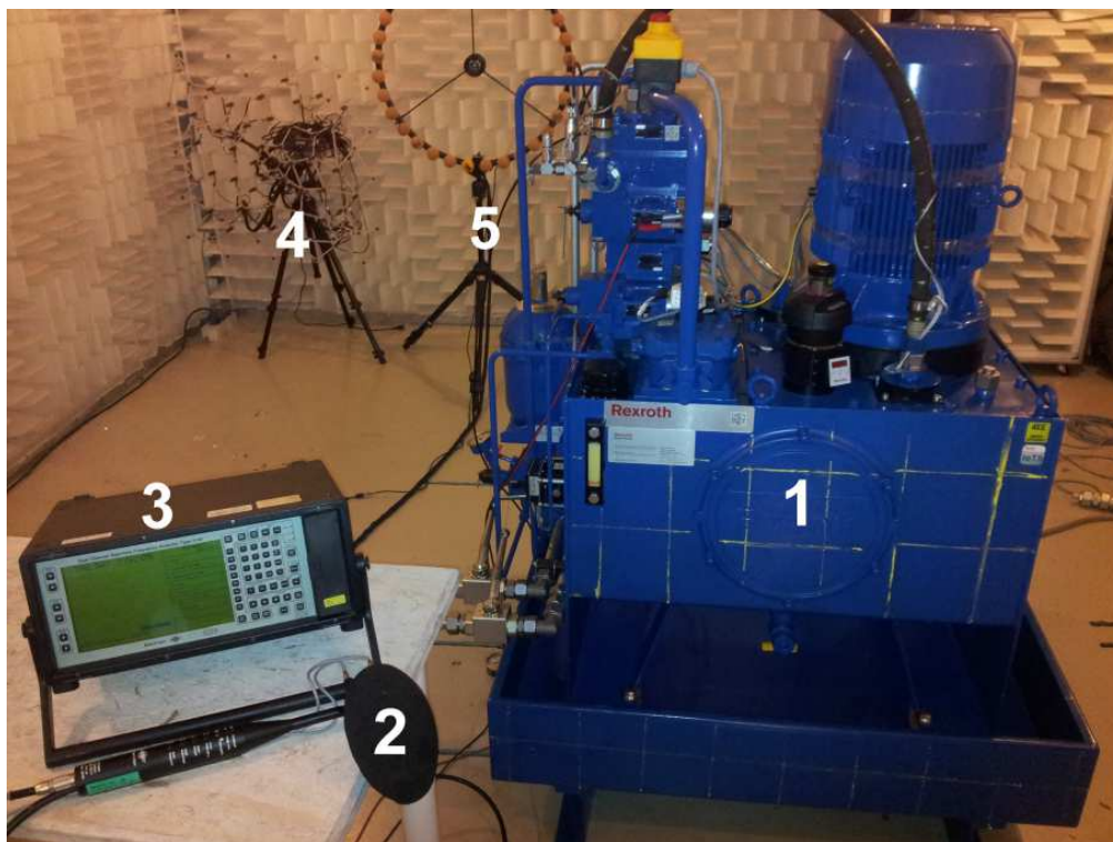
Rys. 2. 1 – Agregat hydrauliczny, 2 – Sonda dwumikrofonowa 3548 B&K, 3 – Analizator 2144 B&K, 4 – Kamera akustyczna Noise Inspector CAE, 5 – Kamera akustyczna GFaI Fig. 2. 1 – Hydraulic unit, 2 – Intensity probe 3548 B&K, 3 – Signal analyzer 2144 B&K, 4 – Acoustic camera Noise Inspector CAE, 5 – Acoustic camera GFaI
