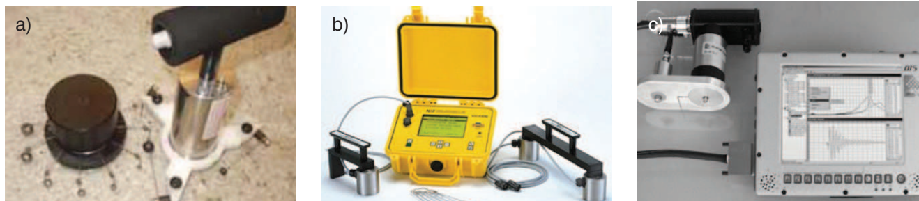
Rys. 5. Dostępne na rynku zestawy impact-echo: a) uchwyt na czujnik i dystansowniki dla kulek typu Spider [16], b) urządzenie NDT James Instruments [15], c) kompaktowy zestaw: elektroniczny impactor DAI-I, urządzenie sterujące i rejestrujące wyniki impact-echo [17]
