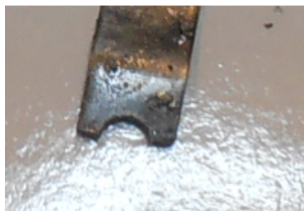
Rys. 6. Fragment pokrywy łożyska wychylnej tarczy oporowej: a) model komputerowy z mapą naprężeń zredukowanych, b) rzeczywisty uszkodzony element
