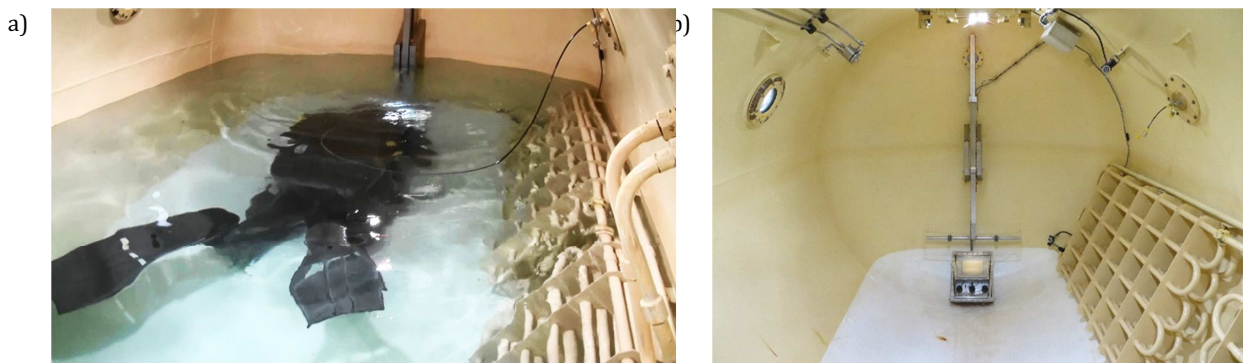
Rys. 2 Basen komory dekompresyjnej „Kobuz” przed zainstalowaniem nowego systemu chłodzenia: a) napełniony wodą podczas eksperymentu, b) bez wody.
