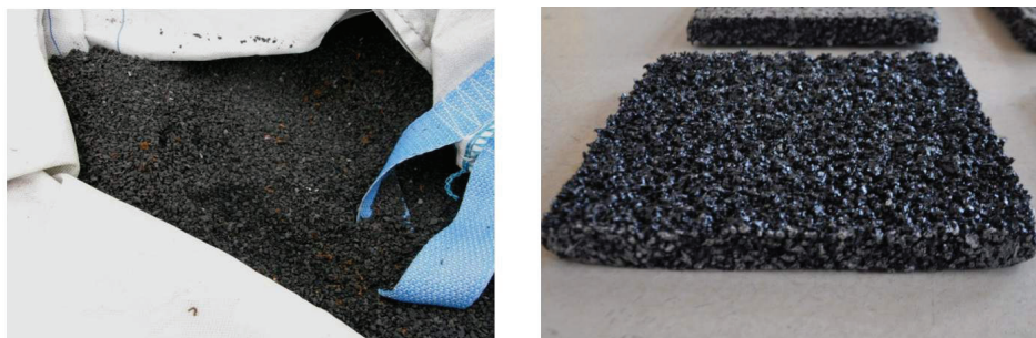
Fot. 1. Granulat gumowy w pojemniku transportowym typu big bag i próbka przeznaczona do badań
