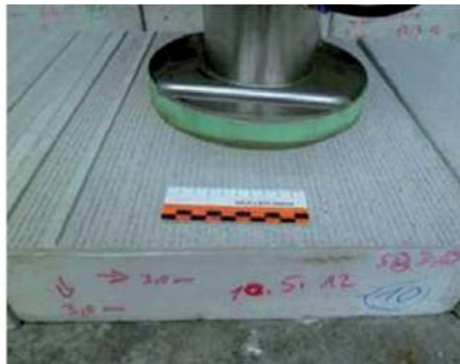
Fot. 6. Pomiary tekstury: a) (z lewej) z zastosowaniem profilometru laserowego, b) (z prawej) indukowanego poprzez teksturę oporu przepływu powietrza na nawierzchni [2]
