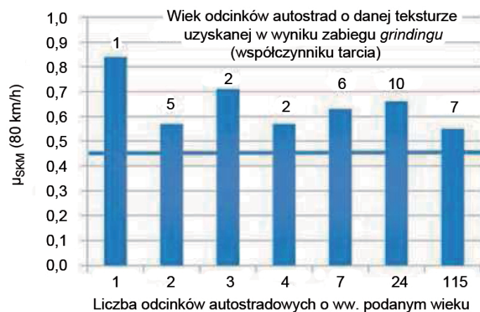
Rys. 2. Wyniki pomiarów współczynnika tarcia uzyskane na badanych odcinkach nawierzchni poddanej zabiegowi typu grinding (współczynnik tarcia pomierzony metodą pomiaru siły bocznej)
