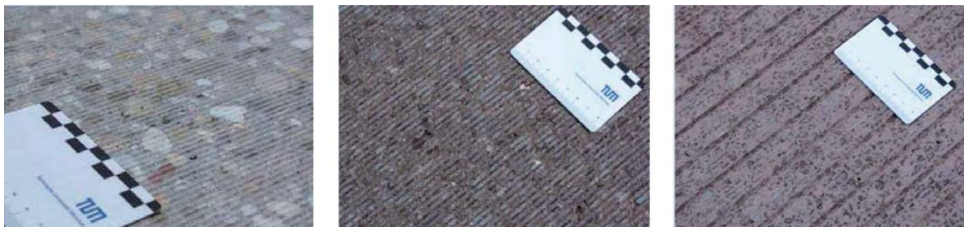
Fot. 9. Odcinek doświadczalny drogi A5 – zdjęcia tekstury na przykładzie betonu nr 2; z lewej tekstura nr 1, w środku tekstura nr 2, z prawej tekstura nr 3 [5 i 6]
