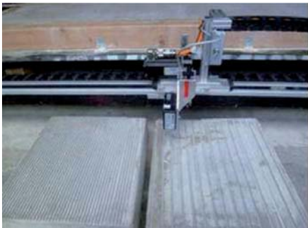
Fot. 6. Pomiary tekstury: a) (z lewej) z zastosowaniem profilometru laserowego, b) (z prawej) indukowanego poprzez teksturę oporu przepływu powietrza na nawierzchni [2]
