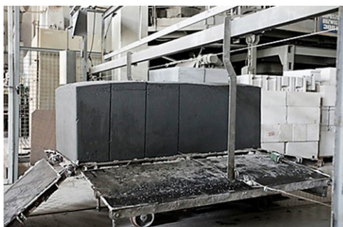
Rys. 1. Masy betonu komórkowego w trakcie krojenia, przed autoklawizacją – skala półtechniczna
