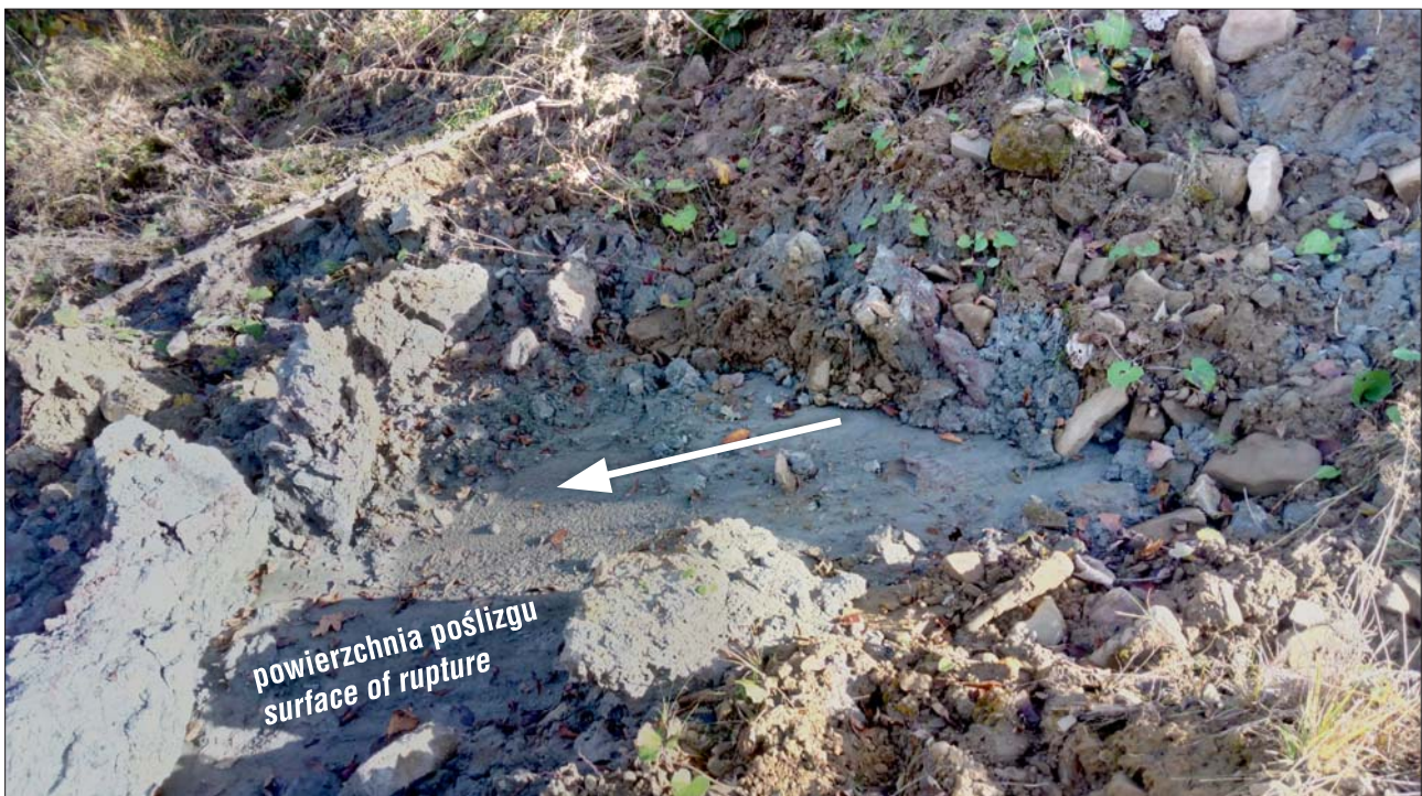
Ryc. 4. Powierzchnia poślizgu odsłaniająca poniżej skarpy głównej w niszy bocznej Fig. 4. Slip surface exposed below the main scarp in a side niche
