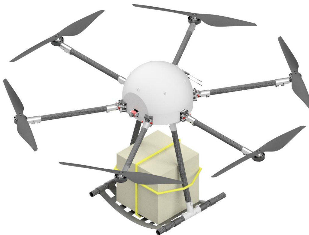
Rys. 16. Koncepcja bezzałogowego statku powietrznego z ładunkiem
