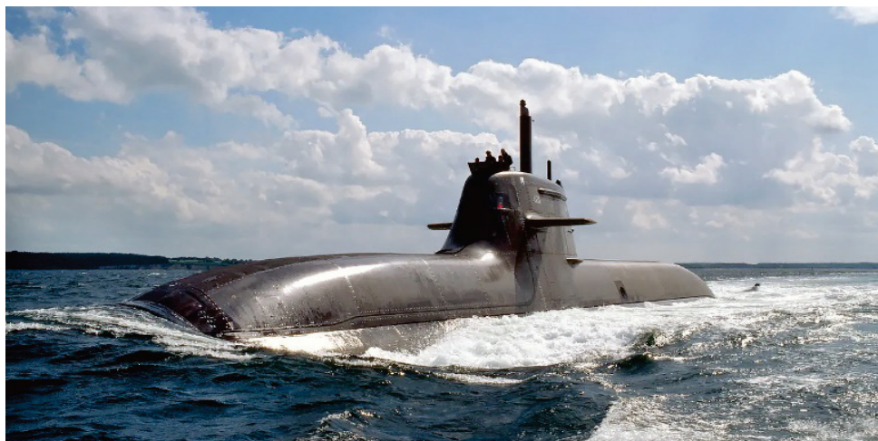
Rys. 7. Okręt podwodny HDW klasy 212A z metanolowym ogniwem paliwowym, testowana na Morzu Bałtyckim [fot. Thyssenkrupp]
