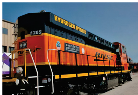
Rys. 4. Prototyp lokomotywy manewrowej i schemat układu z ogniwem paliwowym PEM [14]
