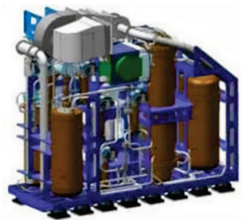
Rys. 6. System reformingu metanolu typu HWD 216 zainstalowany na okręcie podwodnym [5]
