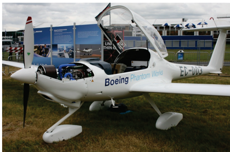
Rys. 3. Diamond HK36 Super Dimona EC-003, wykorzystany przez Boeinga jako demonstrator technologii [fot. Adambro, wikipedia]
