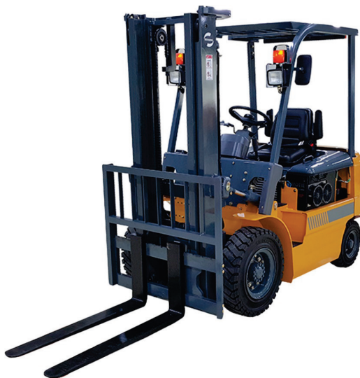
Rys. 5. Wózek widłowy zasilany ze źródła metanolowego układu paliwowego (DMFC), typ DM1500 wraz z buforującą baterią litowo-jonową [materiały reklamowe firmy GaonCell]
