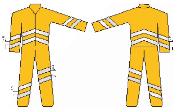
Rys. 6. Przykład skośnego (kąt nachylenia taśm \leq 20^\circ ) rozmieszczenia taśm z materiału odbłaskowego na rękawach, torsie i spodniach ubrania ostrzegawczego
