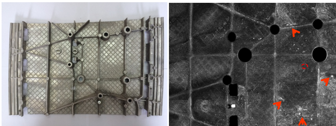
Rys. 4. a) widok próbki do badań przy użyciu mikroskopii akustycznej, b) przykładowy wynik badań z wykorzystaniem metody II w trybie C-scan.
