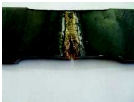
Rys. 11. Zerwana próbka po rozciąganiu z blachy o grubości 2 mm spowodowana wadą widoczną na rys. 2 [oprac. własne]
