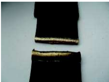
Rys. 10. Zerwana próbka w linii spawu po rozciąganiu z blachy o grubości 3 mm [oprac. własne]
