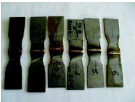
Rys. 9. Przykładowe próbki po rozciąganiu z blachy o grubości 3 mm [oprac. własne]
