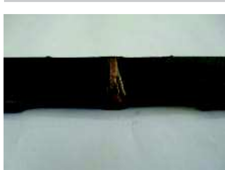
Rys. 11. Zerwana próbka po rozciąganiu z blachy o grubości 2 mm spowodowana wadą widoczną na rys. 2 [oprac. własne]
