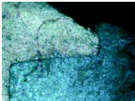
Rys. 4. Miejsce łączenia materiału rodzimego ze spawem od strony lica dla blachy 2 mm i powiększeniu x50 [oprac. własne]
