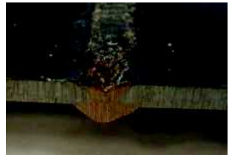
Rys. 2. Przykład próbki o grubości 2 mm z widoczną wadą spawu w postaci krateru [oprac. własne]
