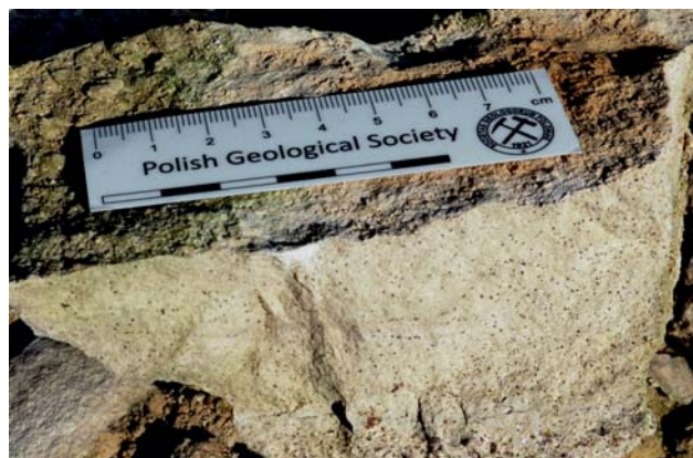
Ryc. 5. Marglisty wapień mikrytowy; formacja z Chmielnika, górny baden; kamieniołom wschodni na górze Kamionce Fig. 5. Micritic marly limestone; Chmielnik Formation Upper Badenian; eastern quarry at Hill Krzemionka
