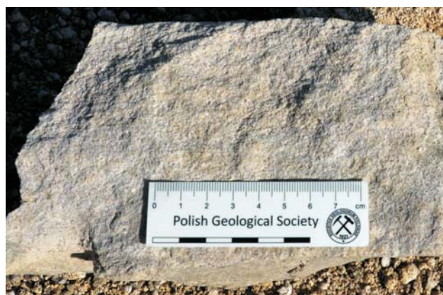
Ryc. 6. Kalkarenit krasnorostowy, drobnoziarnisty do średnioziarnistego, poziomo i skośnie laminowany w małej skali; formacja z Chmielnika, górny baden; kamieniołom wschodni na górze Kamionce Fig. 6. Red algal calcarenite, fine- to middle-grained, small-scale horizontally and cross-laminated; Chmielnik Formation, Upper Badenian; eastern quarry at Hill Krzemionka
