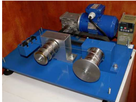
Rys. 7. Przeciągarka podczas przeciągania drutu ze stopu AlMg7 Fig. 7. Wire drawing machine when drawing AlMg7 alloy wire
