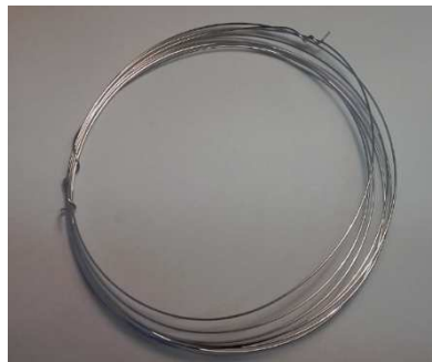
Rys. 8. Przeciągnięty drut ze stopu AlMg7, o średnicy 1,2 mm Fig. 8. Drawn AlMg7 alloy, with diameter of 1.2 mm
