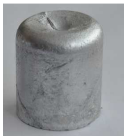
Rys. 2. Gąska ze stopu AlMg7
