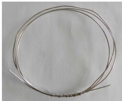
Rys. 6. Drut ze stopu AlMg7, o średnicy 2,0 mm, wyciśnięty metodą KOBO Fig. 6. AlMg7 alloy wire, 2.0 mm in diameter, extruded using KOBO method
