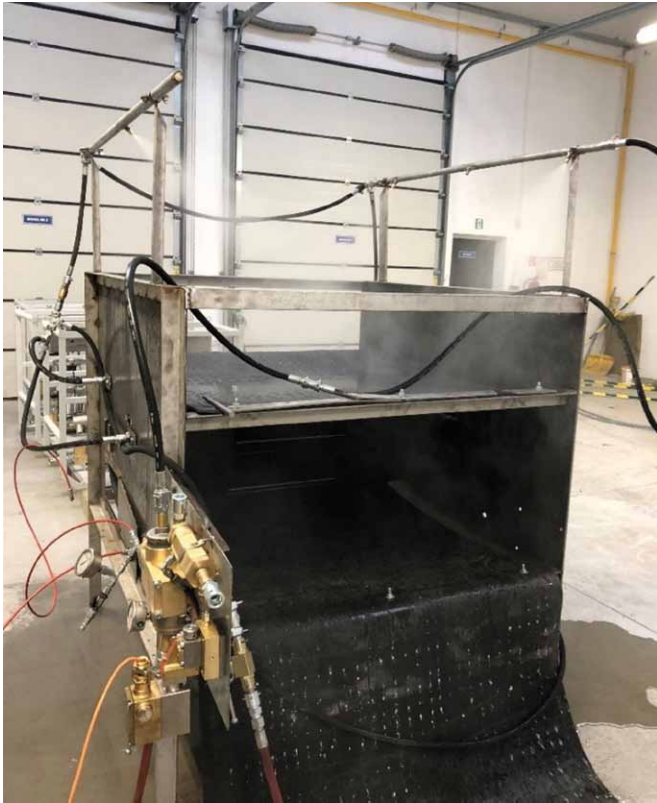
Rys. 7. Woda rozpylana przez dysze mgłowe baterii gaszącej [2]
