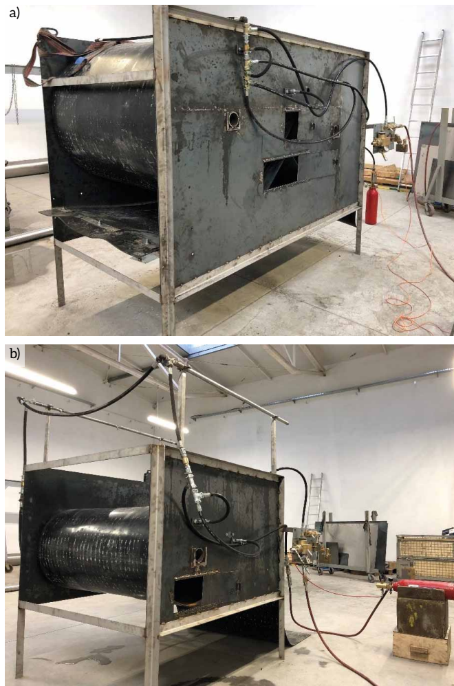
Rys. 4. Stanowisko badawcze z zabudowanym systemem gaszenia mgłowego: a) napędu; b) zwrotni/wysięgніка [2]
