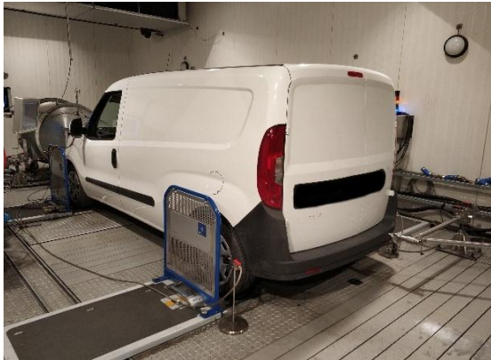
Rys. 2. Pojazd badawczy w trakcie testu na hamowni podwoziowej
