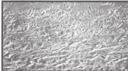
RYS. 3. Miejscowe wytrawienia powierzchni próbki po 28 dniach elektrostymulacji (SEM, 500x).
