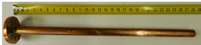
Rys. 5. Widok wyciśniętego pręta Cu-Cr-Zr metodą KOBO
