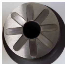
Rys. 4. Widok czołowej powierzchni stempla do wyciskania metodą KOBO
