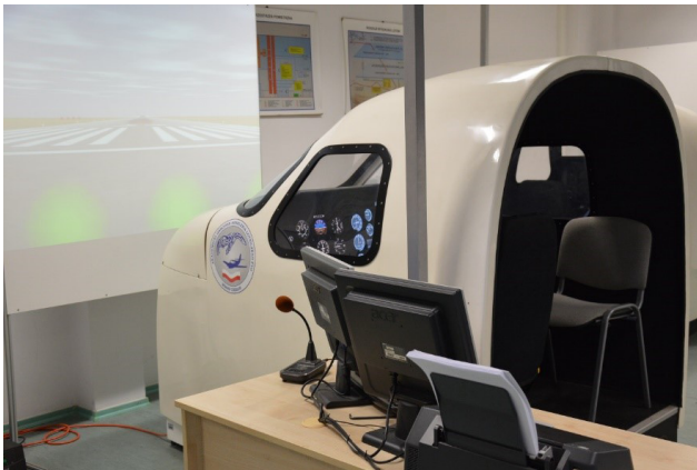
Fot. 2. Widok ogólny urządzenia do podstawowego szkolenia w lotach według wskazań BITD Elite S-612 Cessna 172 RG
